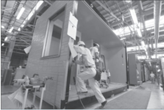
Unidades de casas modulares avanzan por la línea de producción mientras empleados de Toyota Motor Corporation laboran en su proceso de ensamblado en la planta Kasugai Housing Works de la compañía, una de las fábricas de casas con el nombre de marca Toyota localizada en Kasugai, Prefectura Aichi, Japón. Toyota ingresó al sector de la vivienda hace 30 años y en sus plantas aplica la tecnología y la experiencia que adquirió produciendo autos.
